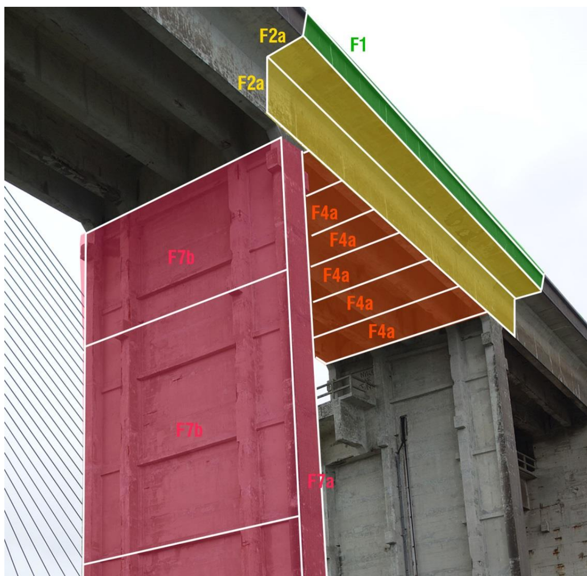
Principe de pose des filets sur le tablier routier des travées d'accès et sur piles
